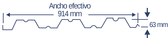
PROPIEDADES DE LA SECCIÓN DE ACERO: FY= 37000 LBS PJG 2 (2603 Kg/cm 2 )
